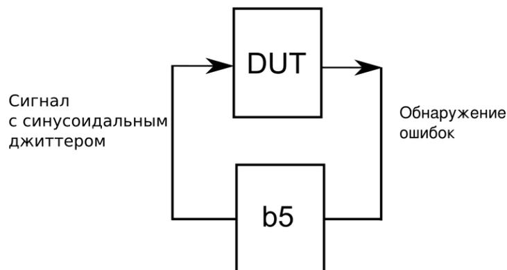
Рисунок 10.3. Измерение максимально допустимого джиттера
