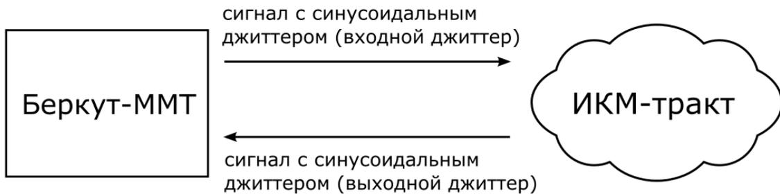
Рисунок 10.2. Измерение передаточной характеристики джиттера
