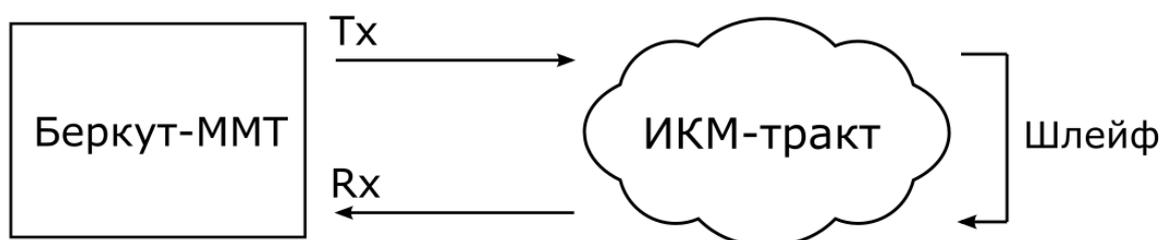
Рисунок 8.3. Схема с выводом канала из обслуживания. Вариант 2
