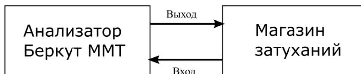
Рисунок 14.2. Определение чувствительности входа приемника
