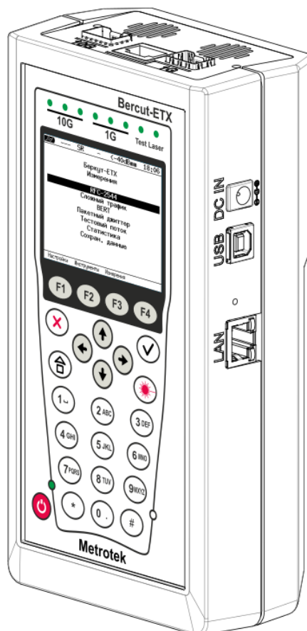
Рисунок 1.1. Внешний вид тестера-анализатора Беркут-ЕТХ
