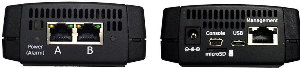
Устройство образования шлейфа Ethernet/Gigabit Ethernet Беркут-ETL предназначено для создания шлейфа на физическом, канальном, сетевом и транспортном уровнях модели OSI в сетях IP/Ethernet. Трафик, поступающий на Беркут-ETL, перенаправляется обратно с возможностью перестановки как MAC/IP-адресов, так и номеров TCP/UDP-портов отправителя и получателя данных.
