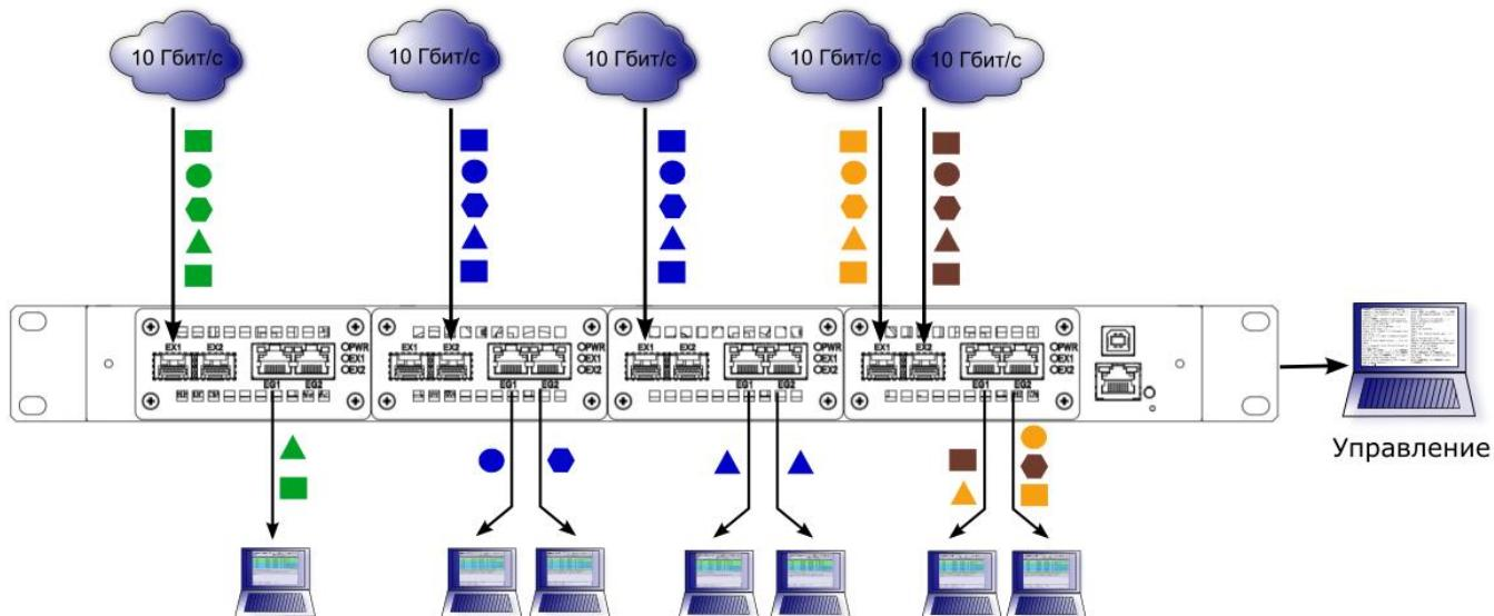
В большинстве случаев для выявления проблем с маршрутизацией, избыточной нагрузкой или несанкционированным трафиком достаточно выбрать из информационного потока некоторую последовательность кадров и декодировать их, чтобы локализовать источник возможных неисправностей.
