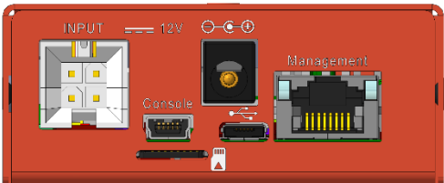
Рисунок 3.5. Задняя панель варианта исполнения M716-02-B
