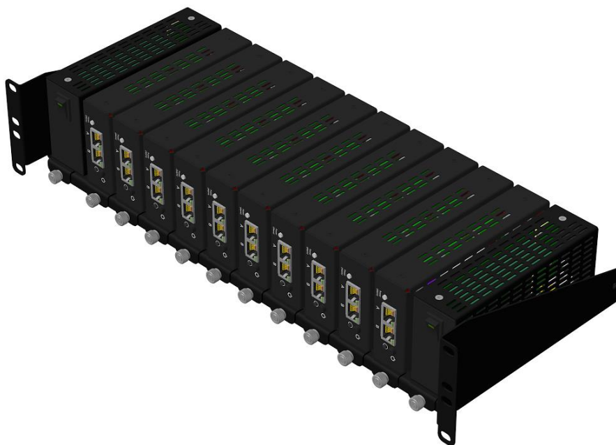
Рисунок 7.4. Полное заполнение полки-шасси
